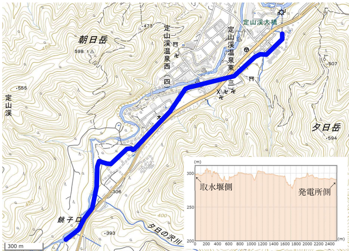
図3 導水路の経路および縦断面図（地理院地図に加筆）
