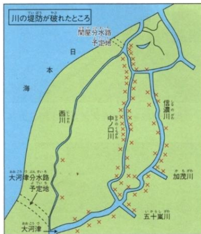
図3 分水路予定地と破堤箇所
